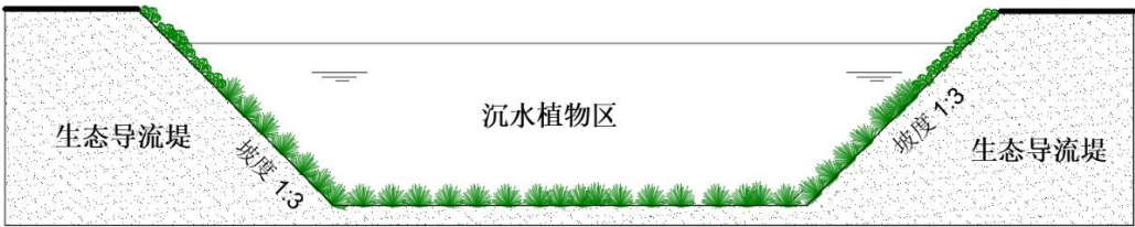
图 5 沉水植物区结构设计
