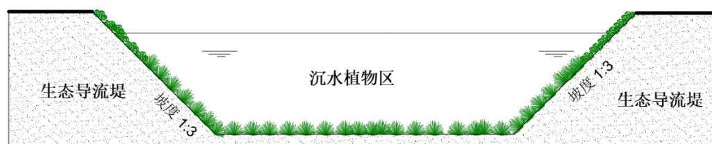
图 6 沉水植物区结构设计
