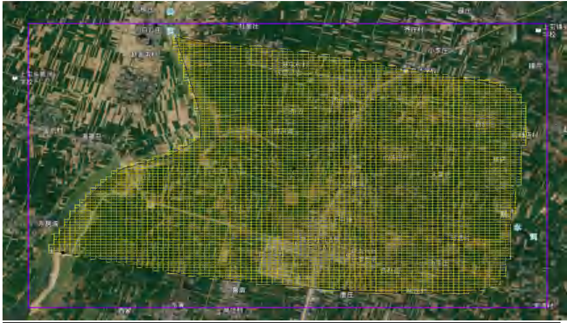
图 5.2-16 模拟区网格剖分平面示意图
