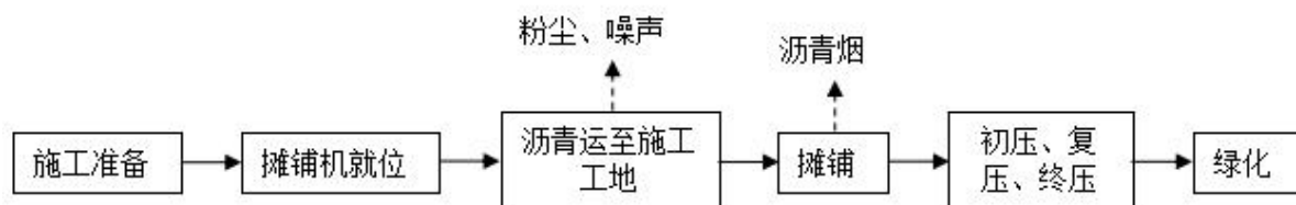
图 5 沥青铺设施工工艺及产污环节示意图
