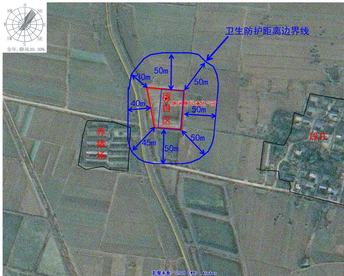
图 8 项目无组织面源卫生防护距离包络线图
