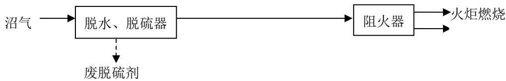
图 2.6-4 沼气利用流程及产污环节图
