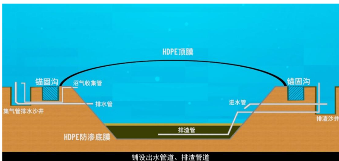
图 5.2-2 全封闭厌氧塘结构示意图
