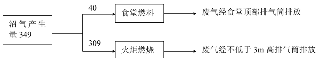
图 2.6-5 本项目夏季（共 122 天）沼气平衡图（单位：m 3 /d）
