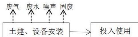
图 3 施工期产污环节
