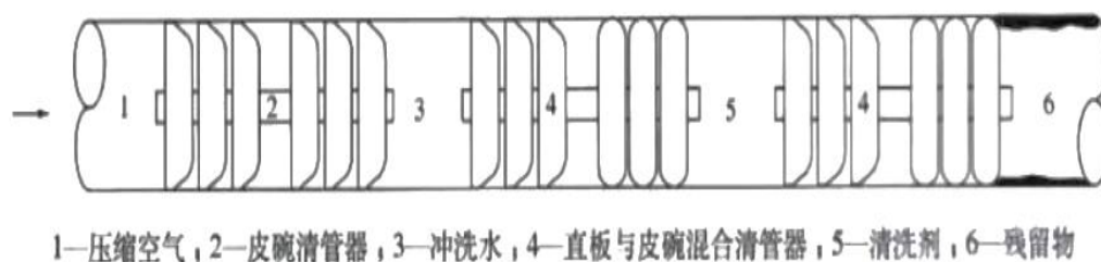
图4.1 管道清洗原理
