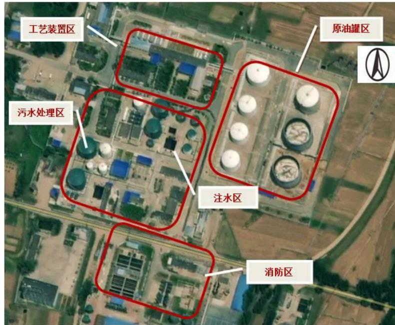
图 2-2 稠油联合站平面示意图
