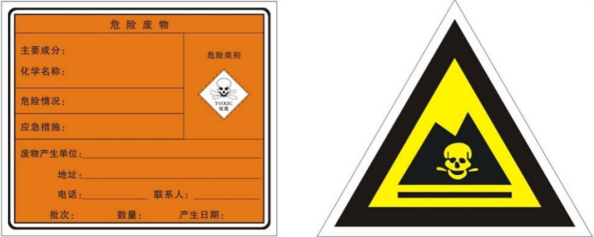
图 5 危废间标识牌
