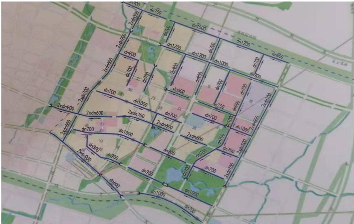
图 2.2-9 商务中心区雨水管网规划图
