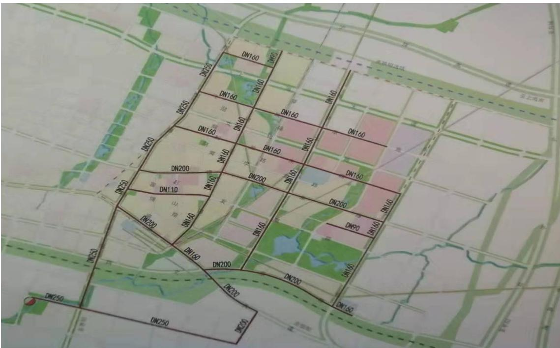
图 2.2-11 商务中心区燃气管网规划图
