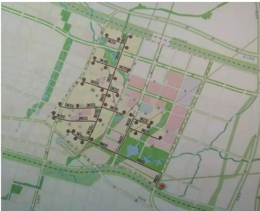
图 2.2-12 商务中心区热力管网规划图
