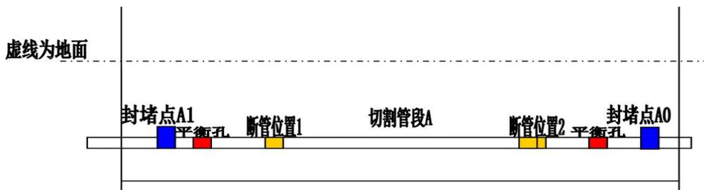
图2.11 封堵作业示意图
