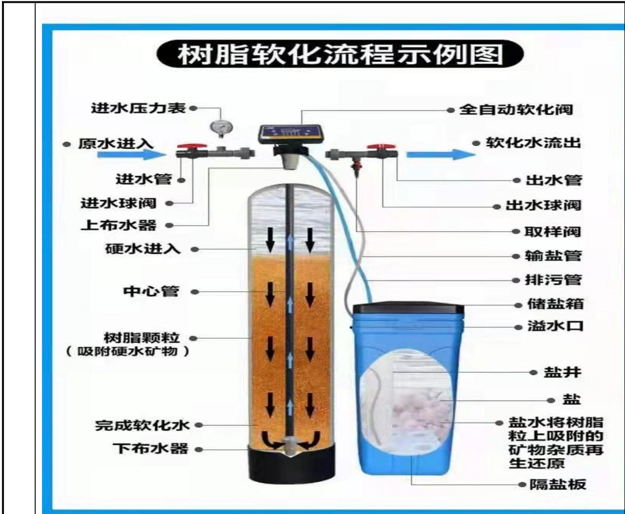
图2-2 锅炉软水制备工艺流程图
