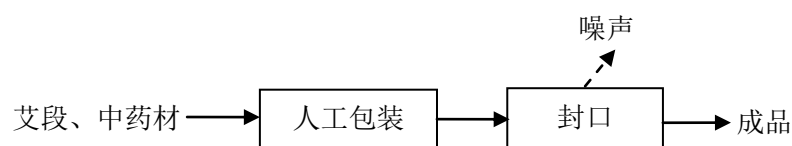
图 2-4 项目足浴包生产工艺流程及产污环节示意图
