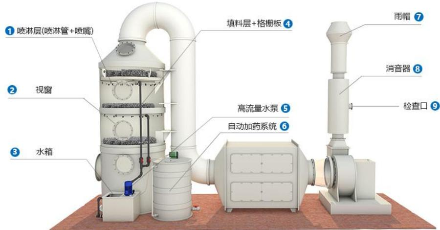
图4-1 酸雾吸收塔结构图
