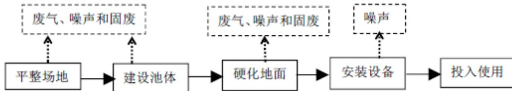
图 2-1 项目施工期工艺流程图
