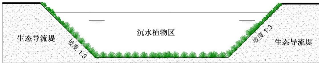
图 3-5 沉水植物区结构设计图
