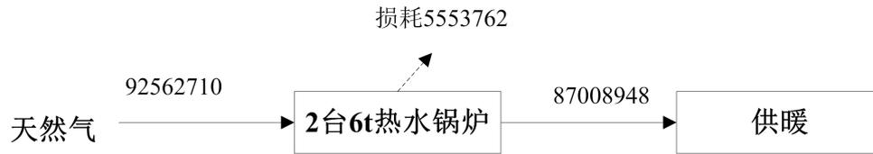
图 1 项目供热平衡图 (MJ/a)
